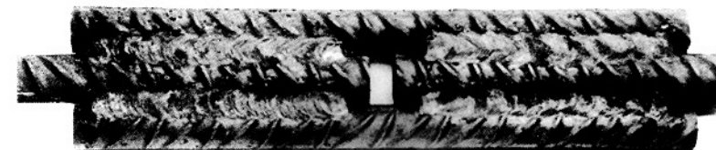
Assemblaggio a sovrapposizione doppia, saldatura a filo continuo di barre da 25 mm.
