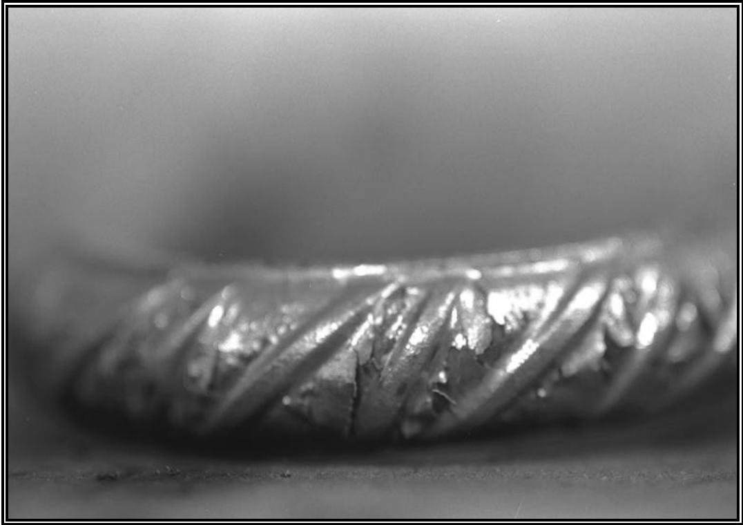
Fig. 10: Particolare di una barra zincata con tecnologia di zincatura non controllata, piegata con un mandrino di 50 mm.
