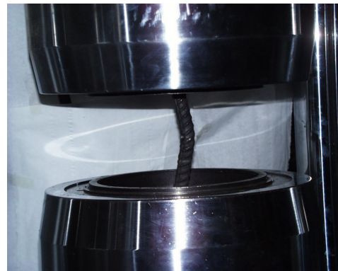
Fig. 5 – Deformazione della barra al termine della fase di compressione.
