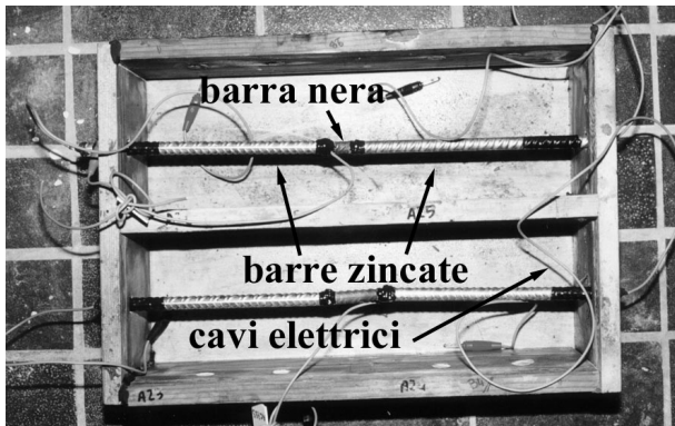
Fig. 10 – Due barre assemblate con rapporto Sa/Sc = 20 (sopra) e Sa/Sc = 7,5 (sotto)
