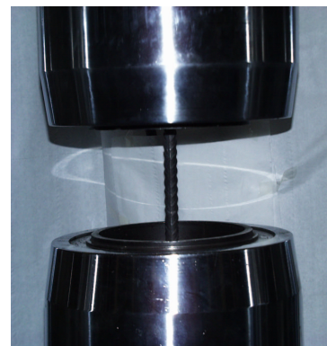
Fig. 2 – Schema di ancoraggio della barra nei morsetti della Instron (a); fotografia della barra all'inizio della prova (b).
