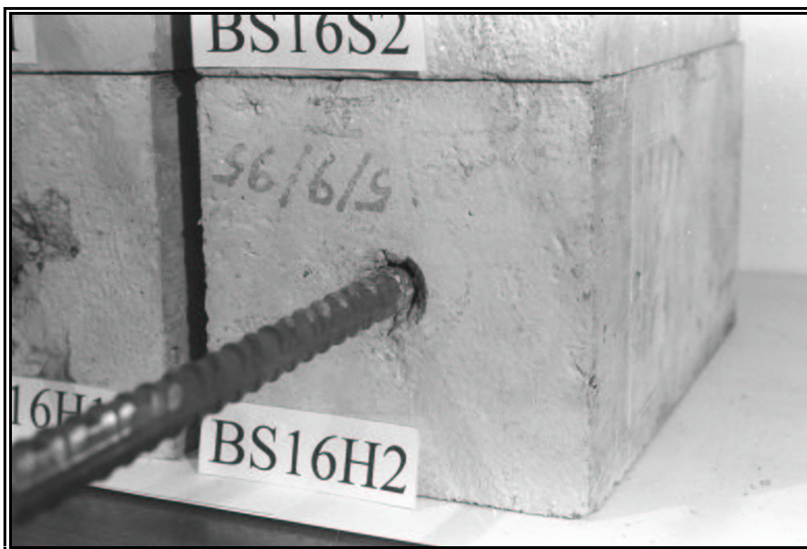
Fig.4.11 Particolare relativo al collasso locale dei puntoni conici di calcestruzzo in corrispondenza della sezione d'inizio dell'ancoraggio, per il provino BS16H2.
