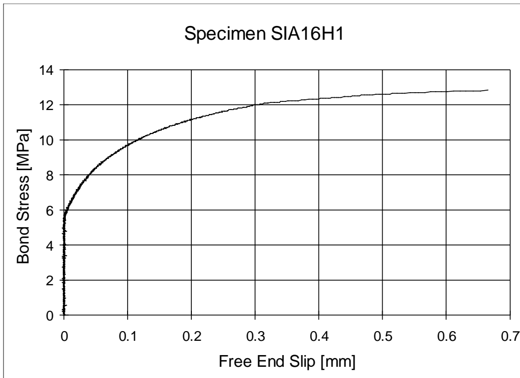
Fig.4.33 Diagramma completo dello sforzo medio di aderenza in funzione dello scorrimento all'estremo libero della barra nel provino SIA16H1.
