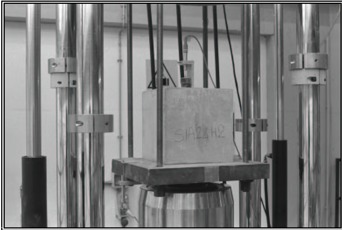
Fig.2.12 Vista della strumentazione applicata al provino inserito nel banco di contrasto.
