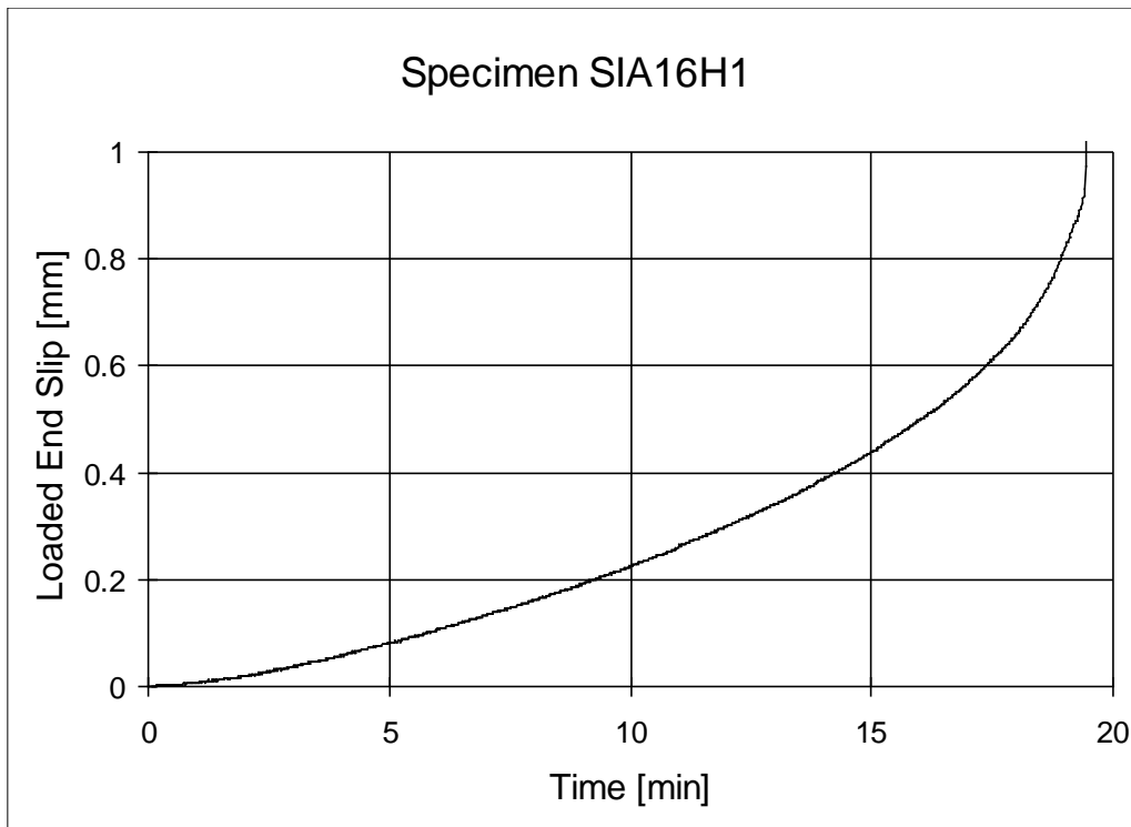
Fig.4.29 Parte iniziale del diagramma dello scorrimento all'estremo caricato della barra in funzione del tempo nel provino SIA16H1.
