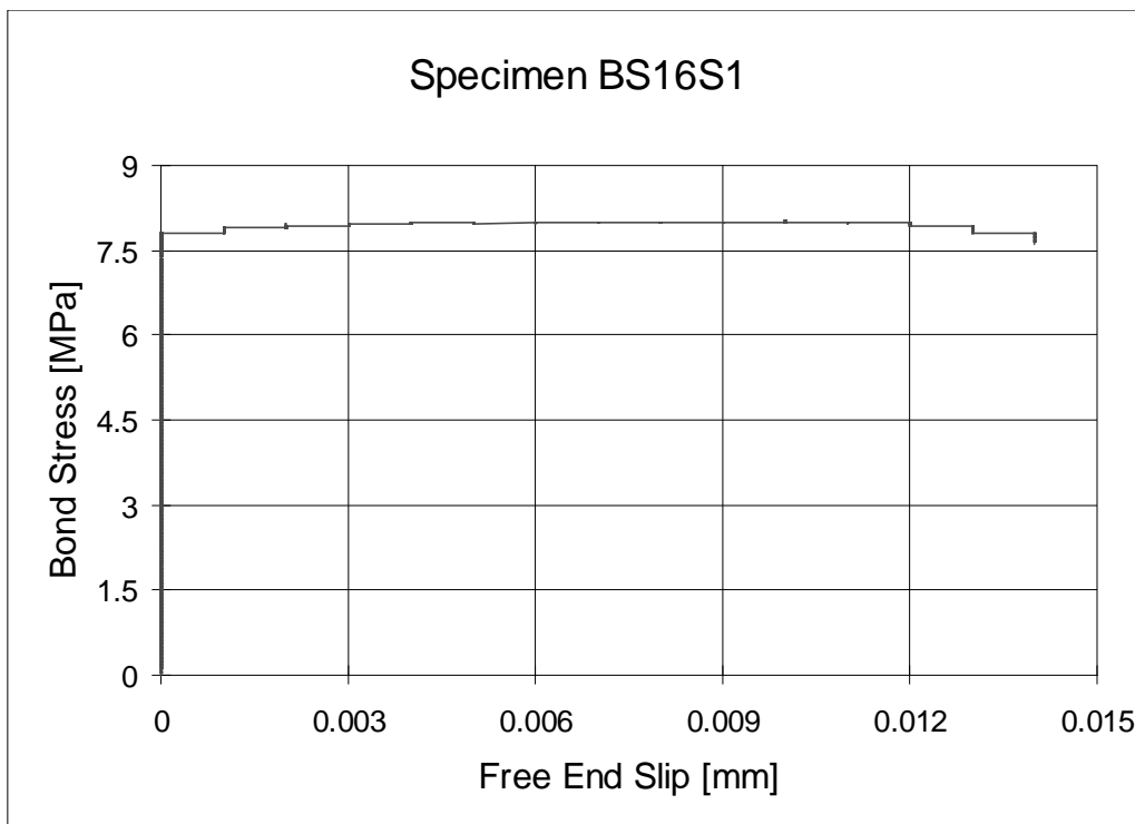
Fig.4.23 Diagramma completo dello sforzo medio di aderenza in funzione dello scorrimento all'estremo libero della barra nel provino BS16S1.
