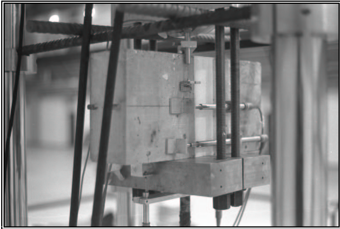
Fig. 2.21 Vista del provino strumentato inserito nel banco di contrasto.
