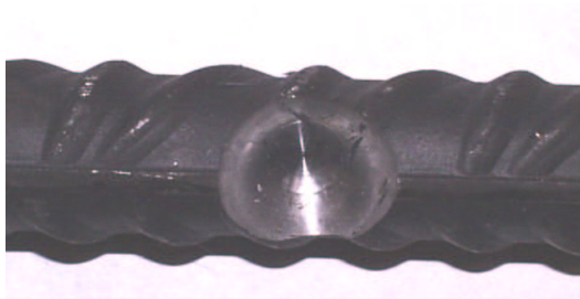
Figura 1 – Particolare di una barra danneggiata artificialmente con una fresa a punta sferica.
