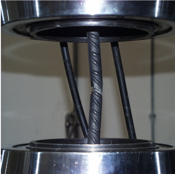
Fig. 11 – Fotografia di una barra tra i morsetti della Instron a fine prova.
